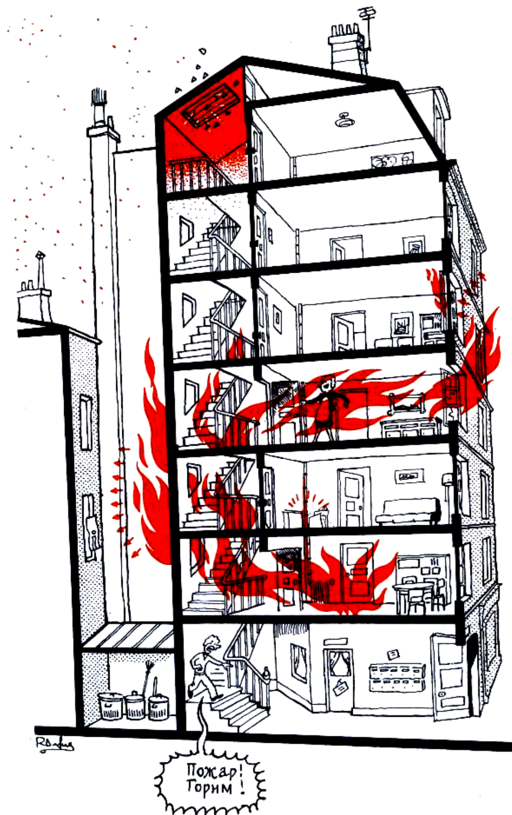
Рис.11. Пути распространения огня.
